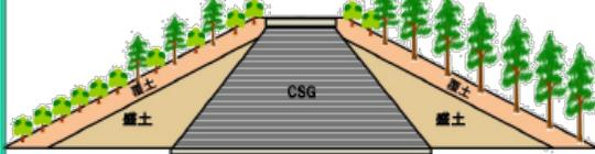
○浜名湖今切口東岸から天竜川西岸までの約17.5kmを対象に、レベル1津波高(最大6.5m)を上回る、高さ13mの防潮堤を整備
