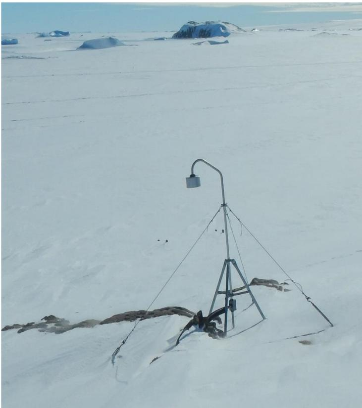
図2 昭和基地で屋外の電場を測定する機器（フィールドミル回転集電器）。
