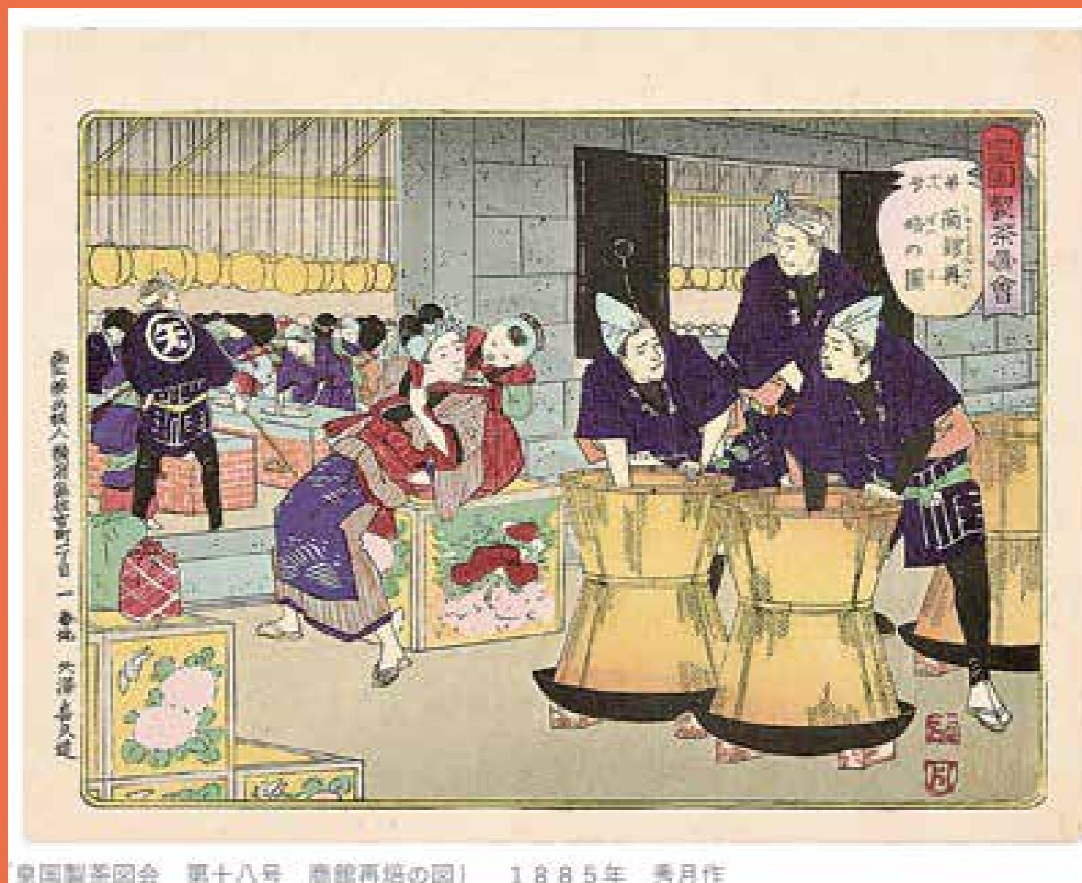
図1 再製作業には、籠の下に炭火を置いて乾燥させる「バスケットファイヤード」と鉄鍋を用いる「パンファイヤード」があった。(ふじのくに茶の都ミュージアム蔵)
